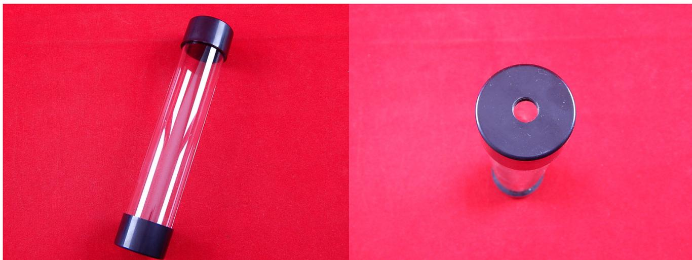
Резервуар (расширительный бачек) считается необязательным компонентом СВО, хотя и присутствует в большинстве систем водяного охлаждения. Системы с резервуаром более удобны в заправке. Объем воды резервуара не принципиален, он не влияет на производительность СВО.
