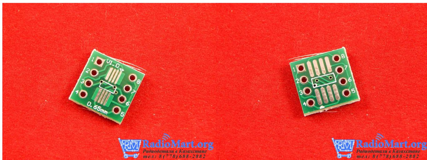
Двухсторонняя плата с разводкой под SMD-корпуса SOIC-8 (150, 208 и 300 mil) и SSOP-8. С помощью ее можно с легкостью изготовить переходник на корпус DIP-8.
