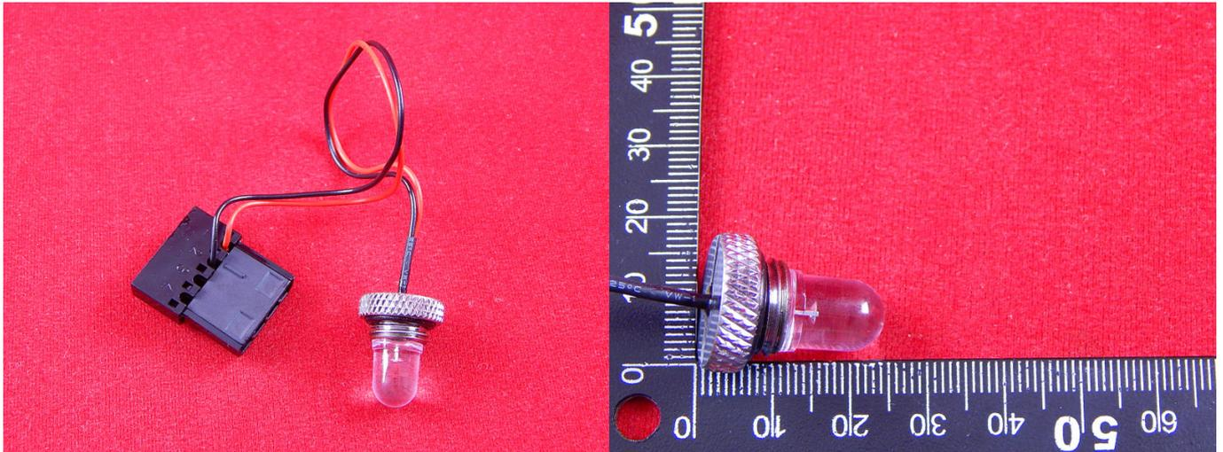
Одноцветная LED-подсветка может поддерживать только один зафиксированный цвет, зеленый. Такая подсветка питается от того же коннектора что и мотор вентилятора или помпы. Это в данном случае MoLEX разъемы.
