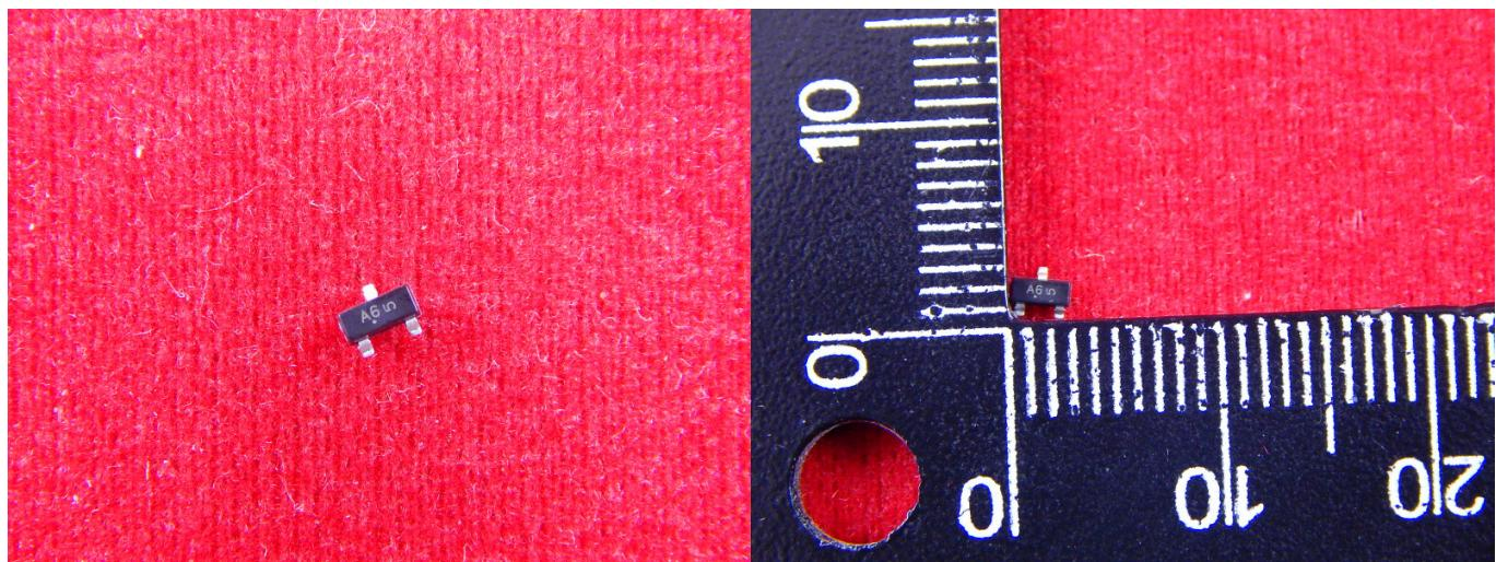
Импульсный диод - это диод с малой длительностью переходных процессов, предназначенный для применения в импульсных режимах работы.
