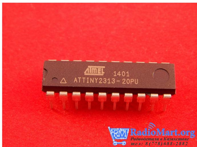
ATtiny2313-20PU - 8 битный микроконтроллер MCU, AVR, 8-бит, FLASH-2 КБайт, EEPROM-128 Байт, RAM-128 Байт, ШИМ кан,-2, DIP20
