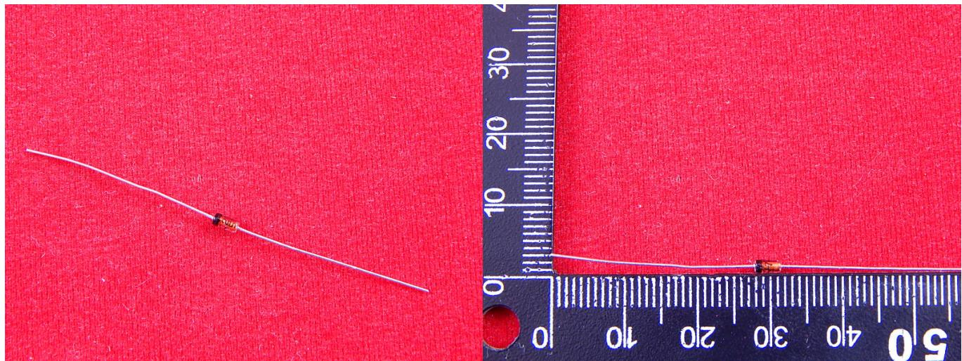
Стабилитрон это полупроводниковый диод, предназначенный для стабилизации напряжения. В отличии от обычных диодов, стабилитрон имеет достаточно низкое напряжение пробоя (при обратном включении) и что самое главное - может поддерживать это напряжение на постоянном уровне при значительном изменении силы обратного тока. Благодаря этому эффекту стабилитроны широко применяются в источниках питания.
