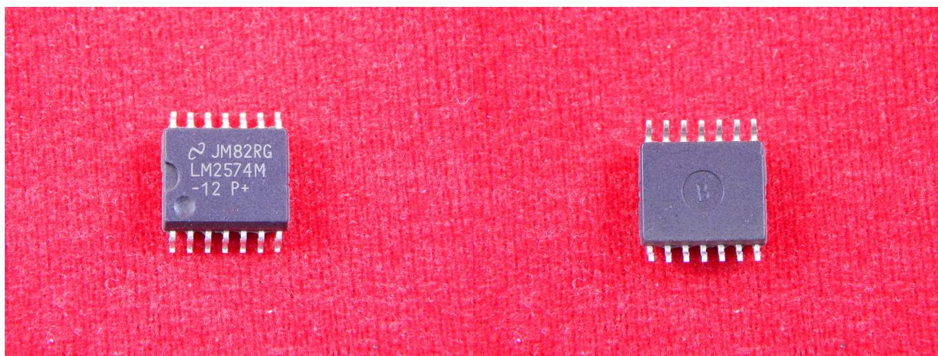
Микросхема — электронная схема произвольной сложности, изготовленная на полупроводниковой подложке и помещённая в неразборный корпус или без такового в случае вхождения в состав микросборки.
