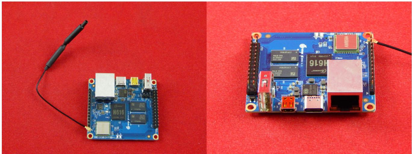
Новая модель, пришедшая на смену Orange Pi Zero. На Pi Zero2 1Gb, в отличие от первой версии, установлен более мощный процессор Allwinner H616 64-bit, частота тоже увеличилась - 1.5GHz, вместе с Dual Band Wi-Fi теперь есть еще и Bluetooth 5.0. Ethernet теперь гигабитный, питание через Type-C, и можно подключать дисплей через microHDMI!
