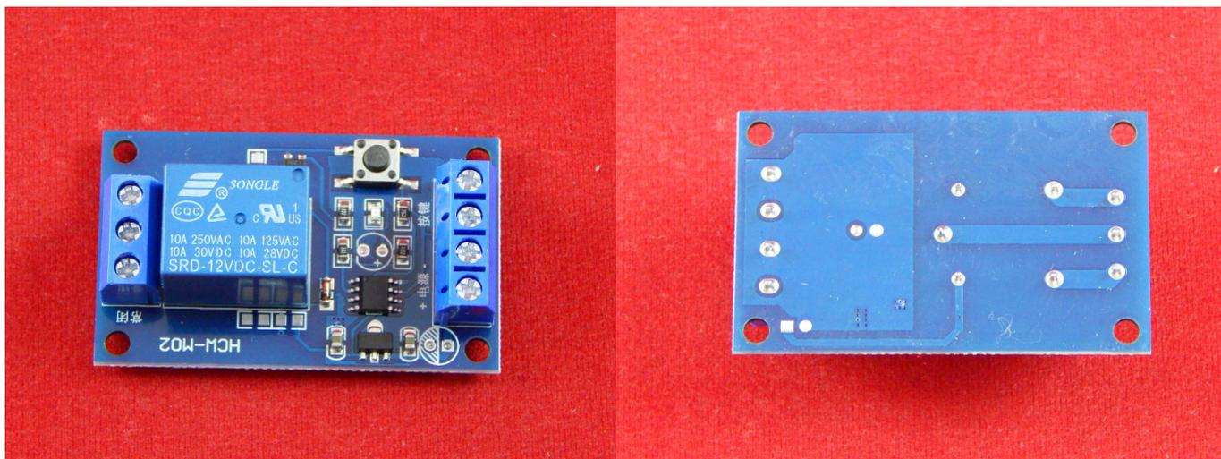
Модуль бистабильного реле - это одноканальный модуль реле на 12 В, управляемый с помощью одной кнопки.
