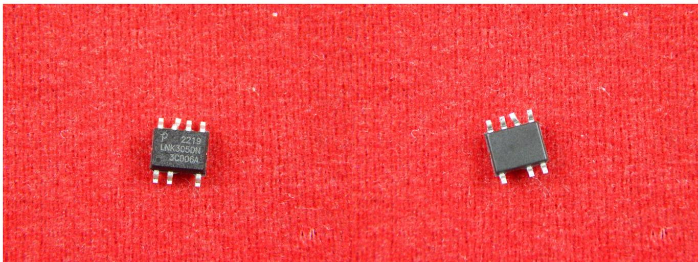
Разработан для замены всех неизолированных источников питания с линейным питанием и питанием от конденсатора в диапазоне выходного тока менее 280мА при равной стоимости системы, обеспечивая при этом гораздо более высокую производительность и энергоэффективность.
