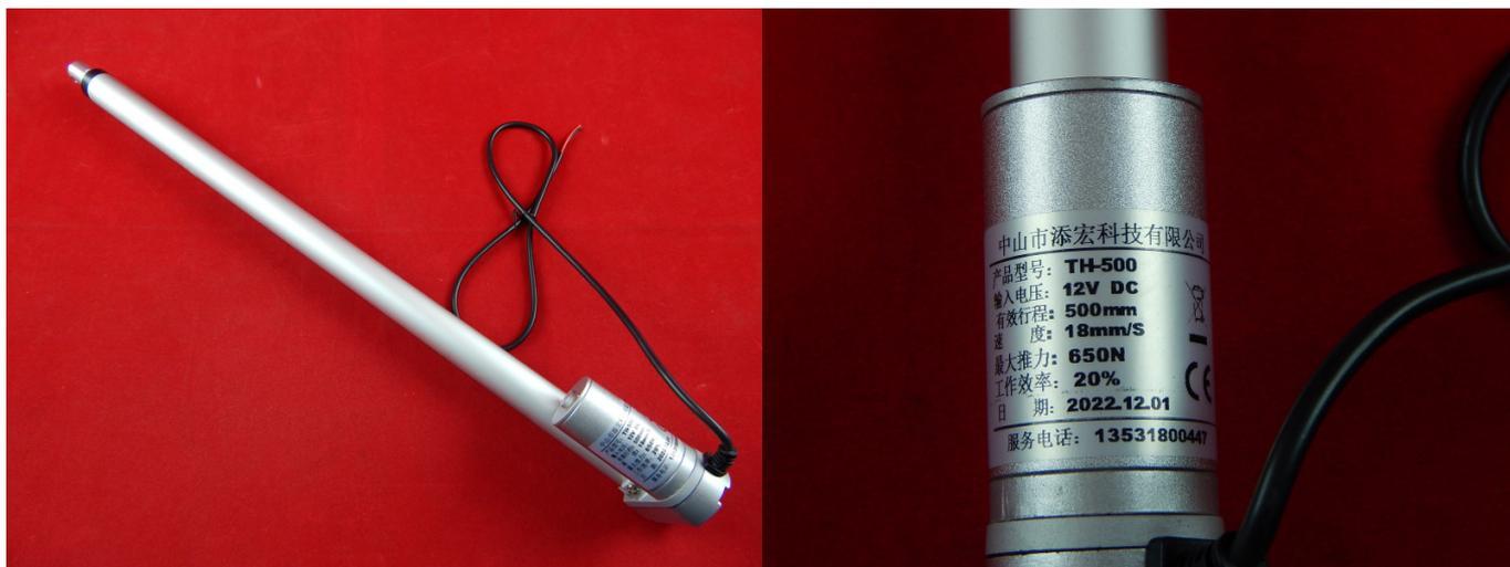
Актуатор 500мм (линейный привод) устроен таким образом, что вращательное движение двигателя постоянного тока преобразуется в линейные движение штока. Линейные приводы получили широкое применение в повседневной жизни. Данный вид можно использовать в инкубаторе для переворота лотков. Для организации реверсивного подключения потребуются электромагнитное реле.
