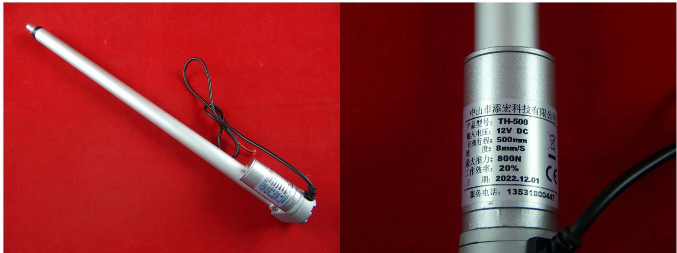
Актуатор 500мм (линейный привод) устроен таким образом, что вращательное движение двигателя постоянного тока преобразуется в линейные движения штока. Линейные приводы получили широкое применение в повседневной жизни. Данный вид можно использовать в инкубаторе для переворота лотков. Для организации реверсивного подключения потребуется электромагнитное реле.
