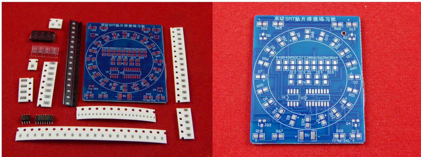
Комплект для обучения пайке SMD деталей: микросхем, транзисторов, резисторов и т.д. различных размеров.
