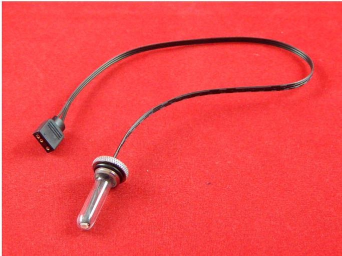
RGB светодиод представляет собой по сути три светодиода в одном корпусе. Чтобы не плодить лишние выводы, все аноды или катоды светодиодов объединяются и получается 4 контакта: R, G, B и общий.
