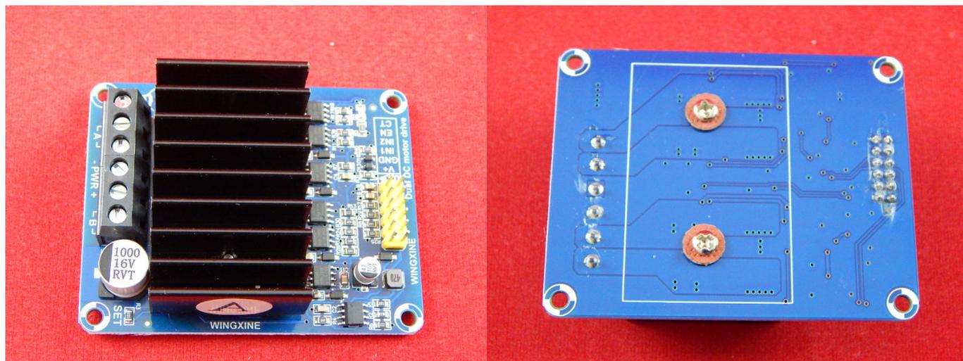
Для управления двигателями необходимо устройство, которое бы преобразовывало управляющие сигналы малой мощности в токи, достаточные для управления моторами. Такое устройство называют драйвером двигателей.
