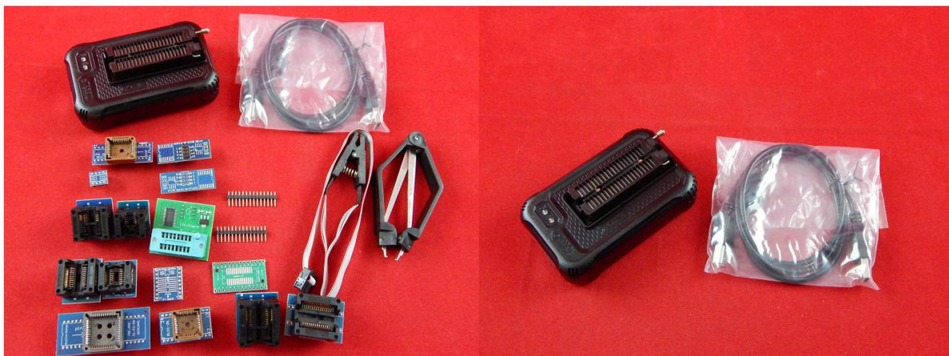
Программатор универсальный XGecu T48 представляет собой третье поколение в линейке серийный устройств, пришедшее на смену широко известному TL866II Plus. Простой и удобный в обращении, XGecu T48 предназначен для программирования мультиформатных чипов энергонезависимой памяти, использующихся во всевозможном электронном оборудовании. Список поддерживаемых микросхем свыше 32000.
