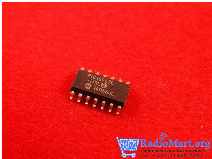
PIC16F676-I/SL - 8 битный микроконтроллер (MCU) 1.75 Kб 64 RAM 12 I/O Ind Temp SOIC14
