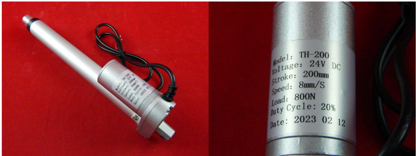
Актуатор 200мм (линейный привод) устроен таким образом, что вращательное движение двигателя постоянного тока преобразуется в линейные движения штока. Линейные приводы получили широкое применение в повседневной жизни. Данный вид можно использовать в инкубаторе для переворота лотков. Для организации реверсивного подключения потребуется электромагнитное реле.
