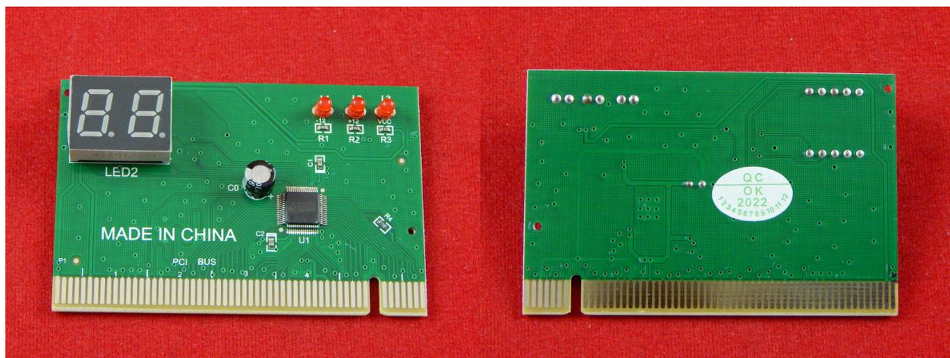
Подключается к компьютеру путем установки в свободный слот PCI ( PCI 1.0, PCI 2.0, PCI 3.0). Светодиоды, размещенные на карте, отвечают за вольтаж четырех линий питания компьютера (+3.3 V, +5 V, +12 V, +3.3 V), цифровой индикатор служит для визуального отображения кодов POST. Является простейшим устройством для тестирования материнской платы.
