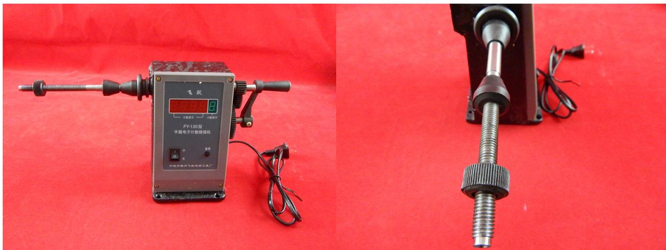
Станок намоточный FY-130 механический с электронным счетчиком. Предназначен для намотки: трансформаторов, дроселей, катушек на каркасы и оправки. Можно мотать медный и алюминиевый обмоточные провода, а также ленты и шины. Используется для ремонта различного электрооборудования и восстановления обмоток электрических машин, а также для различного мелкосерийного и штучного производства.
