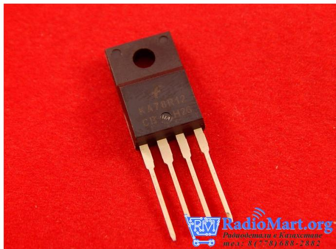
KA78R12, Регулятор с малым падением напряжения, 1А, 12В, TO-220F-4L
