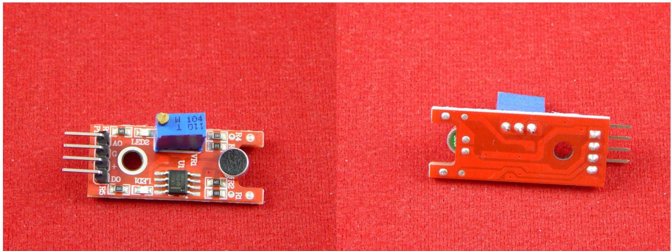
Микрофонный датчик звука Keyes KY-038 умеет определять уровень громкости вокруг него. Он может применяться, например, для включения света по хлопку.
