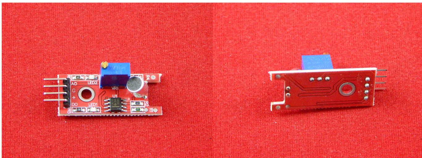
Микрофонный датчик звука Keyes KY-037 умеет определять уровень громкости вокруг него. Он может применяться, например, для включения света по хлопку.
