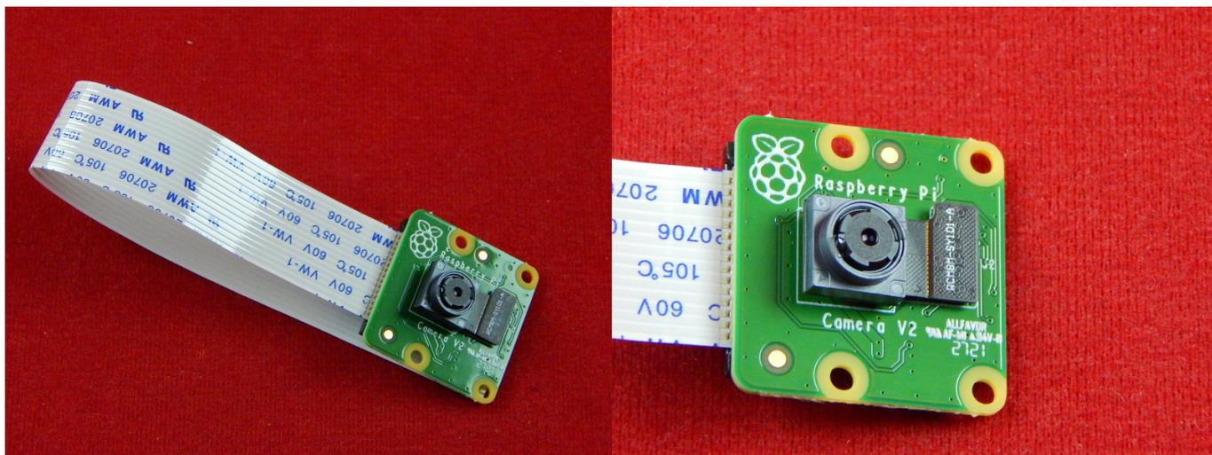
Новинка от Raspberry Pi Foundation - обновленная версия камеры для Raspberry Pi - Raspi CAM v2. Новая камера порадует 8MP сенсором Sony IMX219, улучшенным фиксированным фокусом. Камера позволяет делать статические фото с разрешением 3280 x 2464 пикселей, снимает видео в трех режимах — 1080p @ 30fps, 720p @ 60 fps и 640 x 480p @ 90fps. Поставляется в комплекте со шлейфом.
