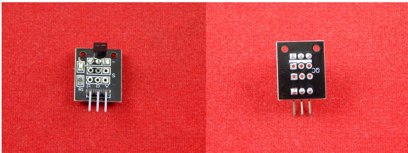
Датчик температуры воздуха с цифровым представлением данных на выходе. Предназначен для работы совместно с микроконтроллером. Основной компонент - микросхема RW18B20, преобразующая температуру корпуса в информацию передаваемую по последовательной двухпроводной шине данных 1-Wire. На шину данных можно установить несколько таких датчиков используя один вывод МК.
