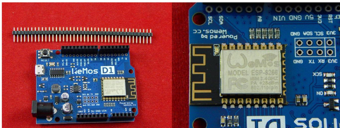
WeMos D1 R2 на ESP8266 - микроконтроллерная плата разработчика, совместимая с Arduino UNO по расположению выводов. Позволяет использовать многие "шилды", предназначенные для Arduino UNO.
