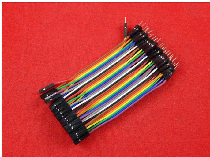
Соединительные провода мама-папа. Используются для удлинения, соединения на платах Arduino, либо как перемычка.
