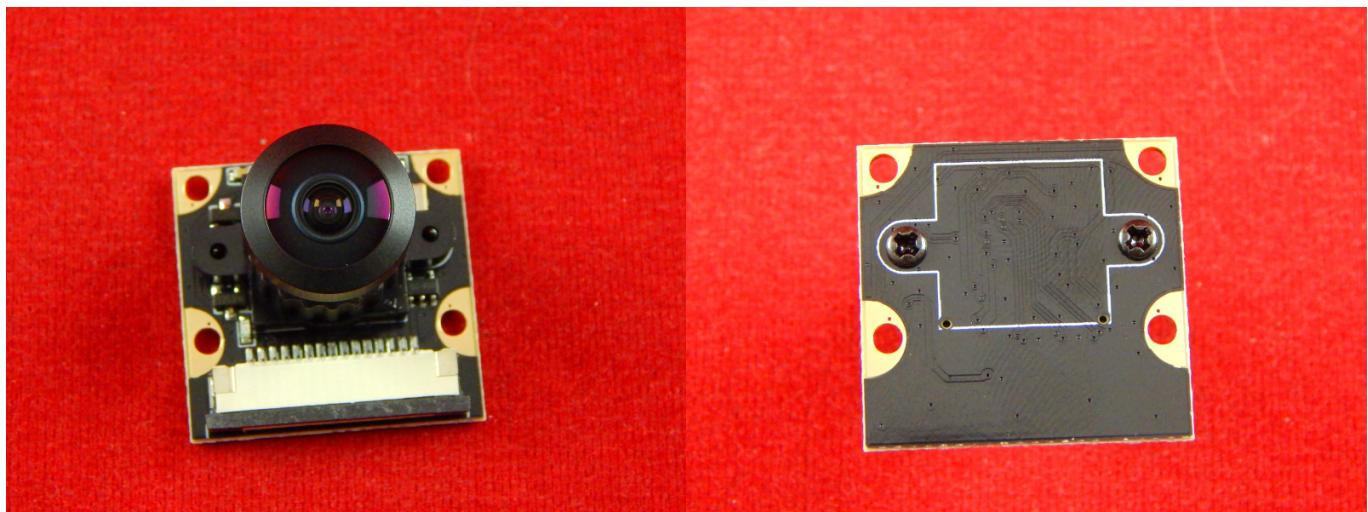
Камера для Raspberry оснащена сенсором OV5647 и имеет разрешение 5 мегапикселей, а также фиксированный фокус. Модуль камеры подключается к плате Raspberry посредством 15-ти жильного плоского шлейфа длиной 15 см, через специальный разъём CSI, который имеет достаточную скорость для передачи видеоданных в форматах до 1080p.
