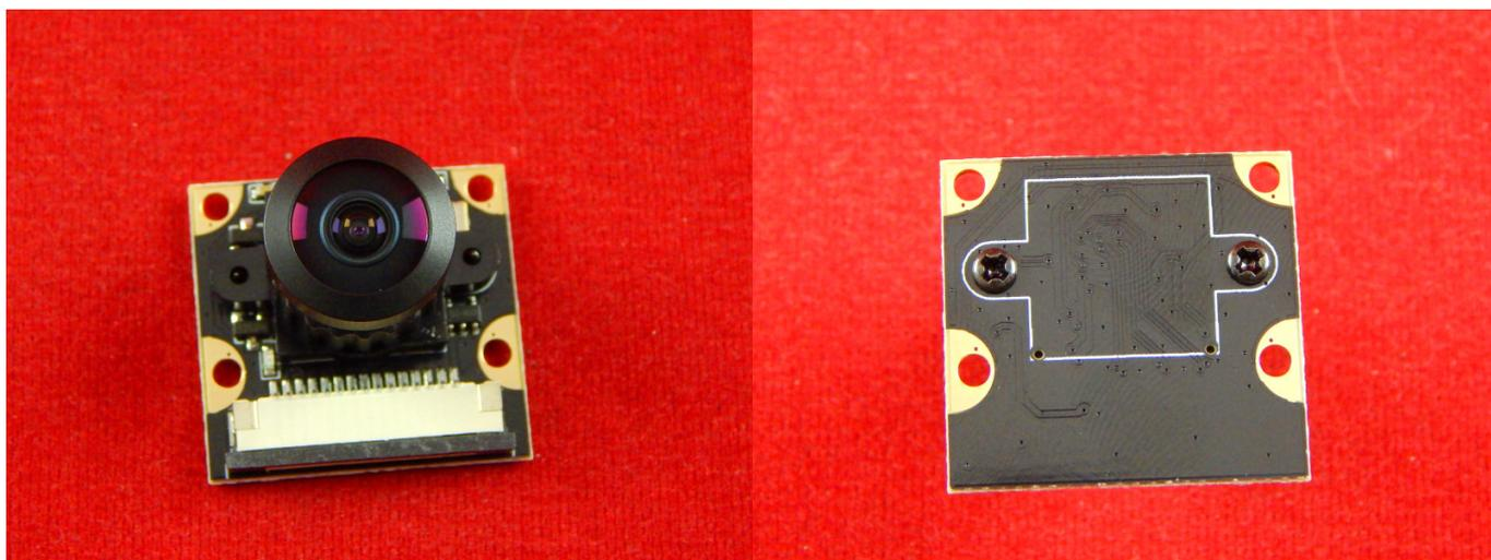
Камера для Raspberry оснащена сенсором OV5647 и имеет разрешение 5 мегапикселей, а так же фиксированный фокус. Модуль камеры подключается к плате Raspberry посредством 15-ти жильного плоского шлейфа длиной 15 см, через специальный разъем CSI, который имеет достаточную скорость для передачи видеоданных в форматах до 1080p.
