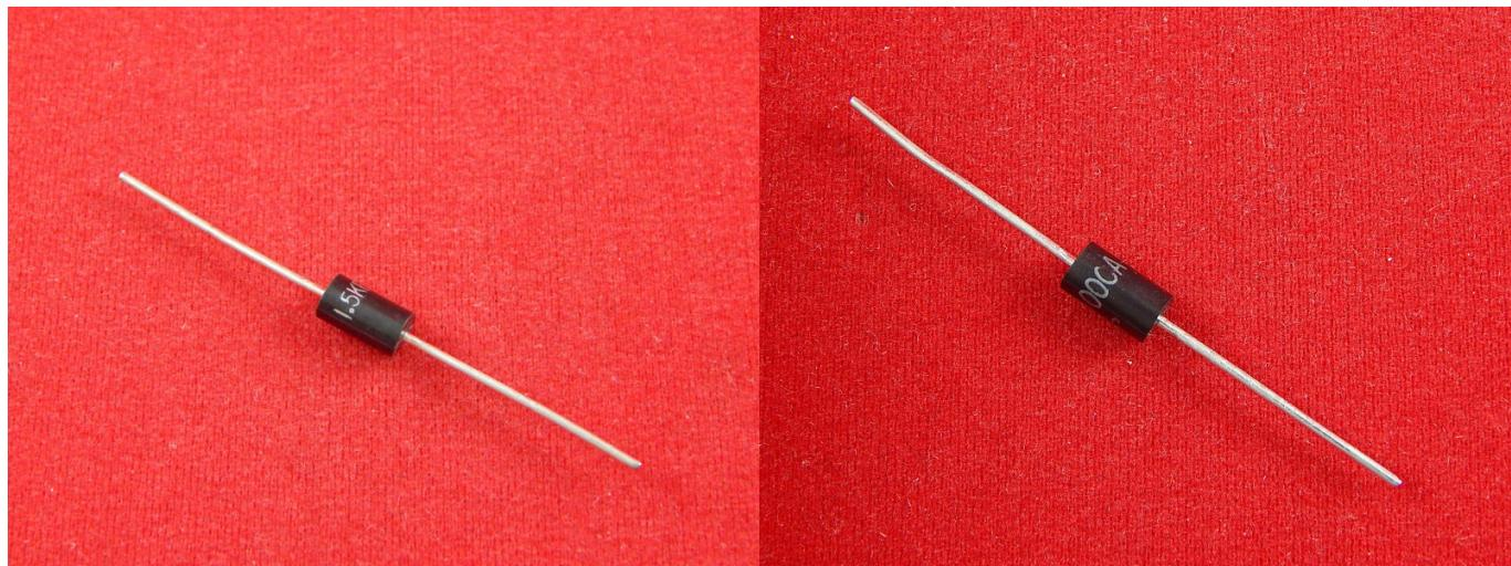
Диоды защитные - полупроводниковые устройства, выполняющие функцию ограничителя напряжения или супрессора, то есть они защищают электронную радиоаппаратуру от электрического перенапряжения. Защитные диоды имеют ярко выраженную нелинейную вольт-амперную характеристику.
