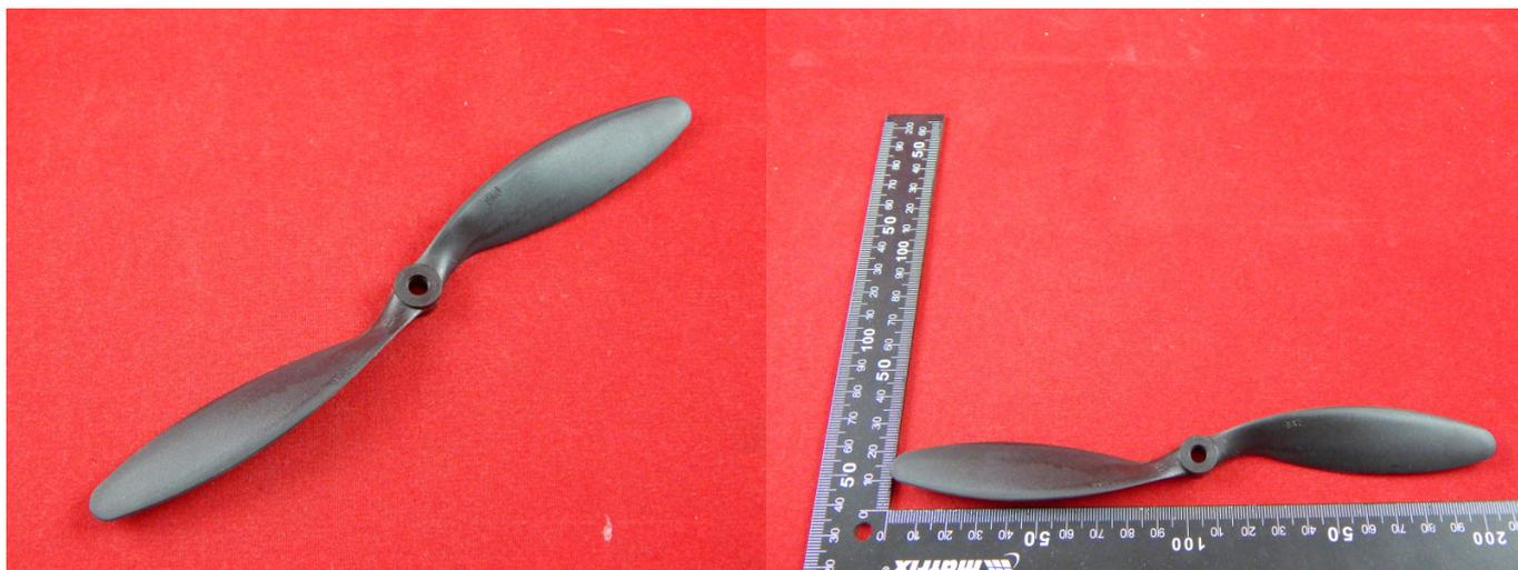
Пропеллер - это лопастной агрегат работающий в воздушной среде, приводимый во вращение двигателем и являющийся движителем, преобразующим мощность двигателя в действующую движущую силу тяги.
