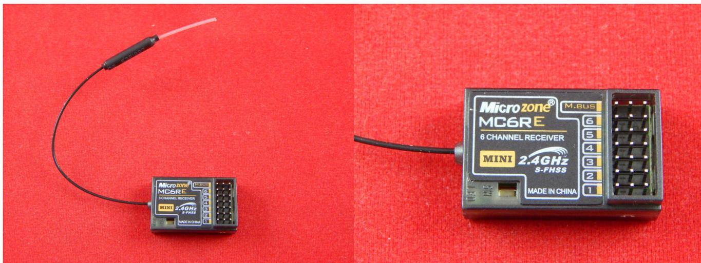
Приемник MC6RE предназначен для построения систем дистанционного управления, работает в диапазоне 2.4 ГГц, имеет 6 каналов управления и поддержку SBUS. Подходящий пульт дистанционного управления: MC6C, E6, MC7, MC10.
