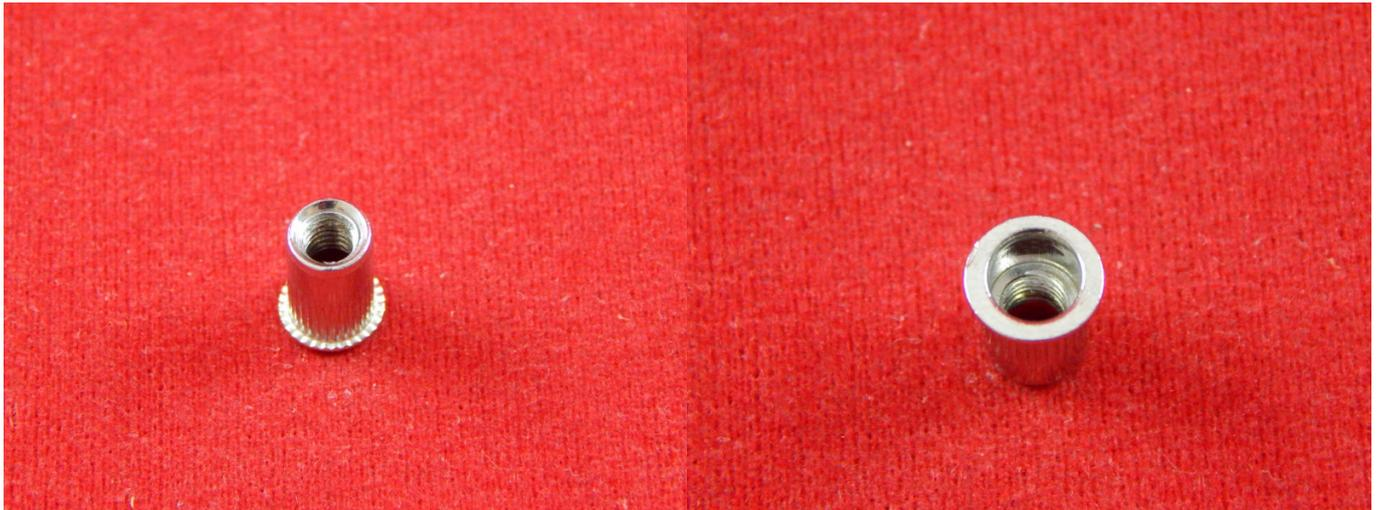
Заклепка-гайка – это крепежное изделие, которое применяется в случаях, когда в листовом металле необходимо выполнить прочную резьбу, а нарезание резьбы по каким либо причинам, невозможно, то есть после установки резьбовой заклепки в нее можно вкрутить болт и тем самым присоединить другую деталь. Стальная заклепка-гайка обладает повышенным показателем прочности.
