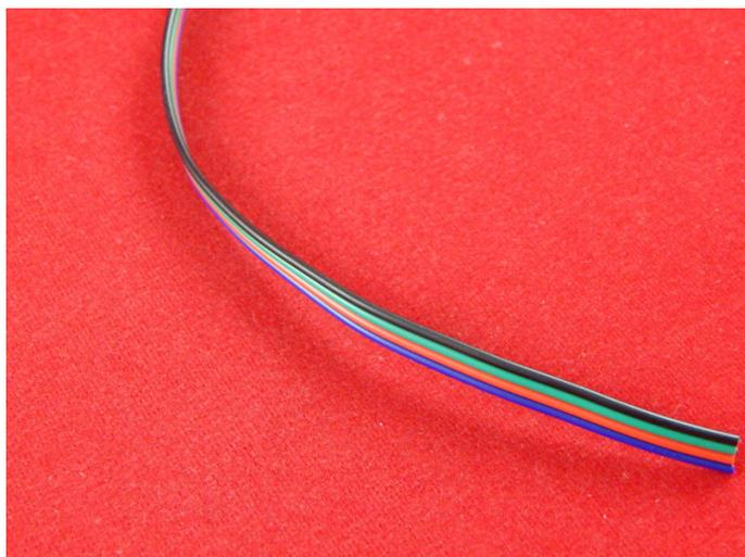
Разноцветный, плоский 4х жильный кабель с сечением 22AWG 0,3мм<sup>2</sup> предназначен для монтажа RGB лент SMD5050 и SMD3528.
