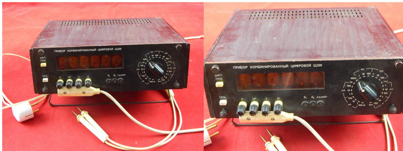
Предназначен для измерения в лабораторных и цеховых условиях постоянного тока, напряжения постоянного тока, сопротивления постоянному току при температуре окружающего воздуха от 10 до 35°C и относительной влажности не более 80%.
