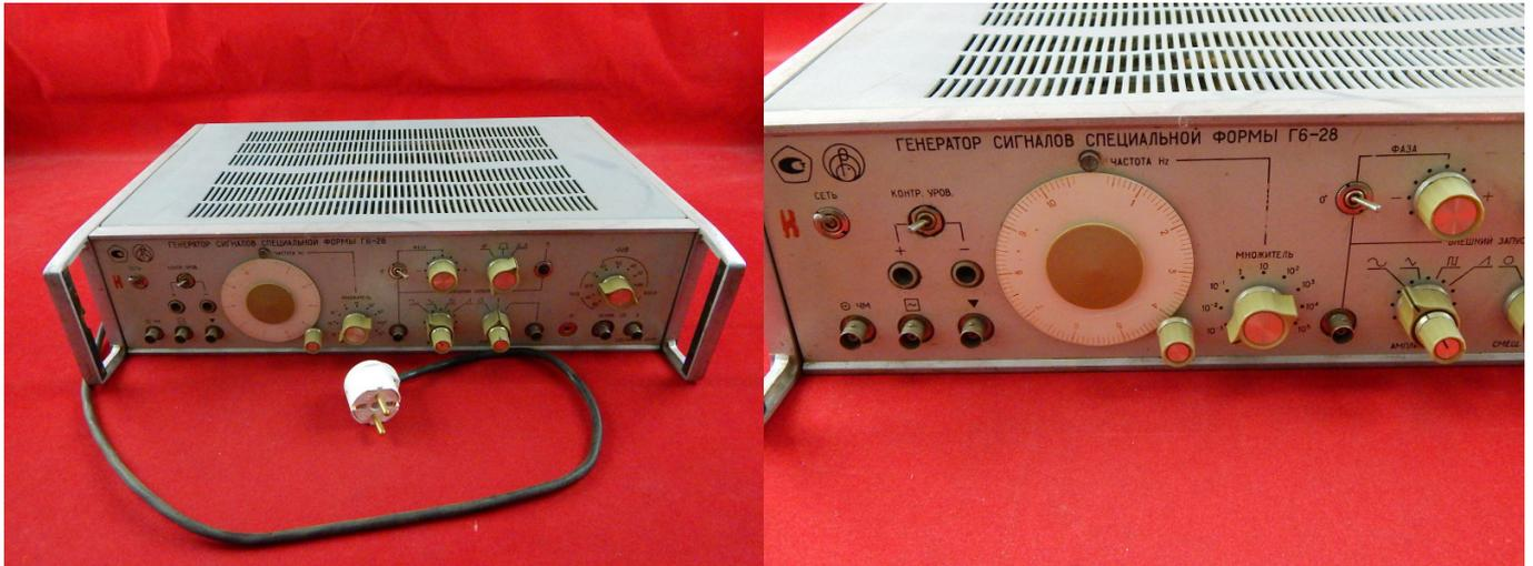
Генератор сигналов Г6-28 — устройство, являющееся источником электрических сигналов в диапазоне инфранизких, низких и высоких частот.
