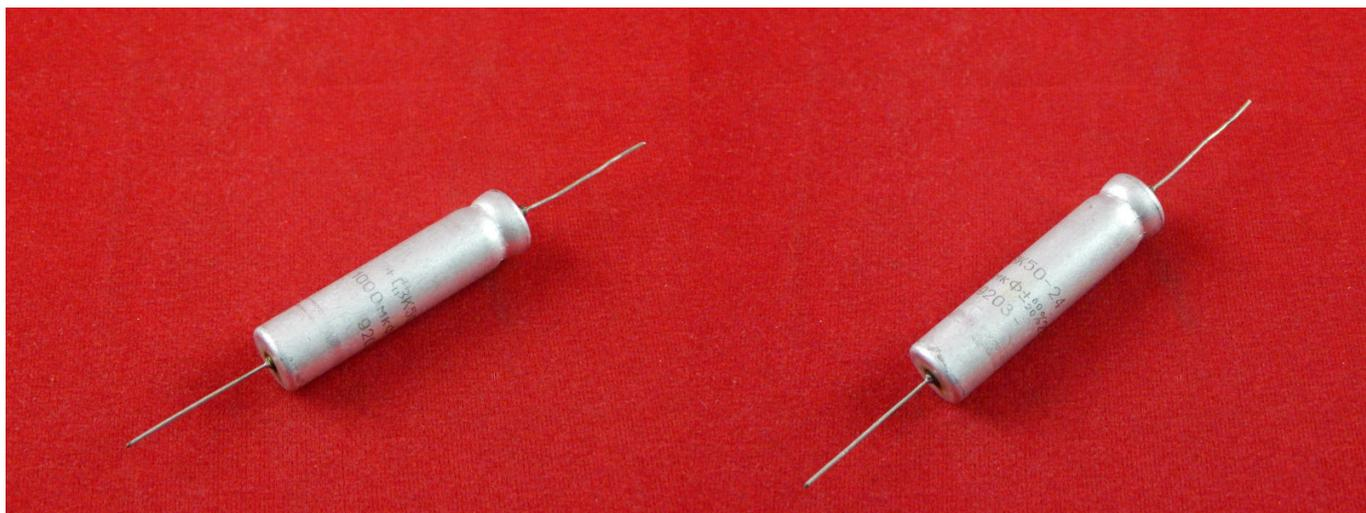
Электролитический конденсатор – один из самых распространённых радиоэлементов. Роль конденсатора в электронной схеме заключается в накоплении электрического заряда, разделении постоянной и переменной составляющей тока, фильтрации пульсирующего тока и многое другое.
