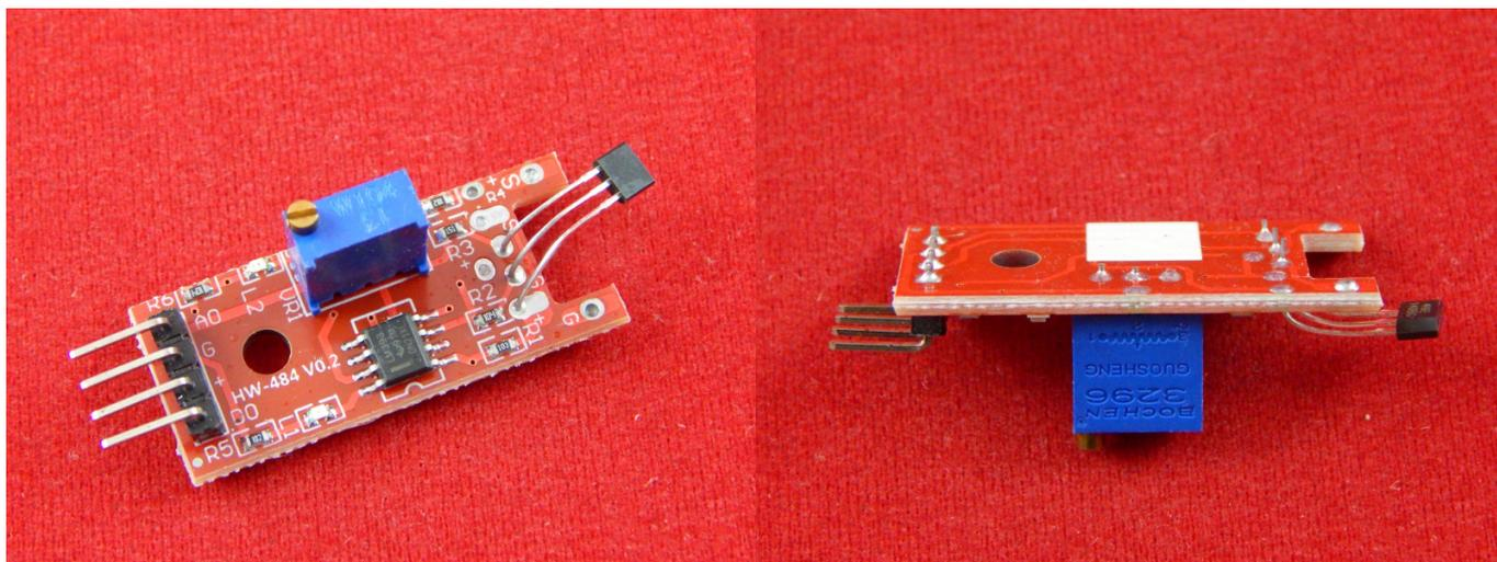
KY-024 — модуль имеет магнитный измеритель Холла, компаратор и имеет многоцелевую систему с Двумя выходами: цифровым и аналоговым. Сможет употребляться для определения магнитного поля вблизи с измерителем. Модуль просто подсоединяется к «Ардуино», либо иным микроконтроллерам.
