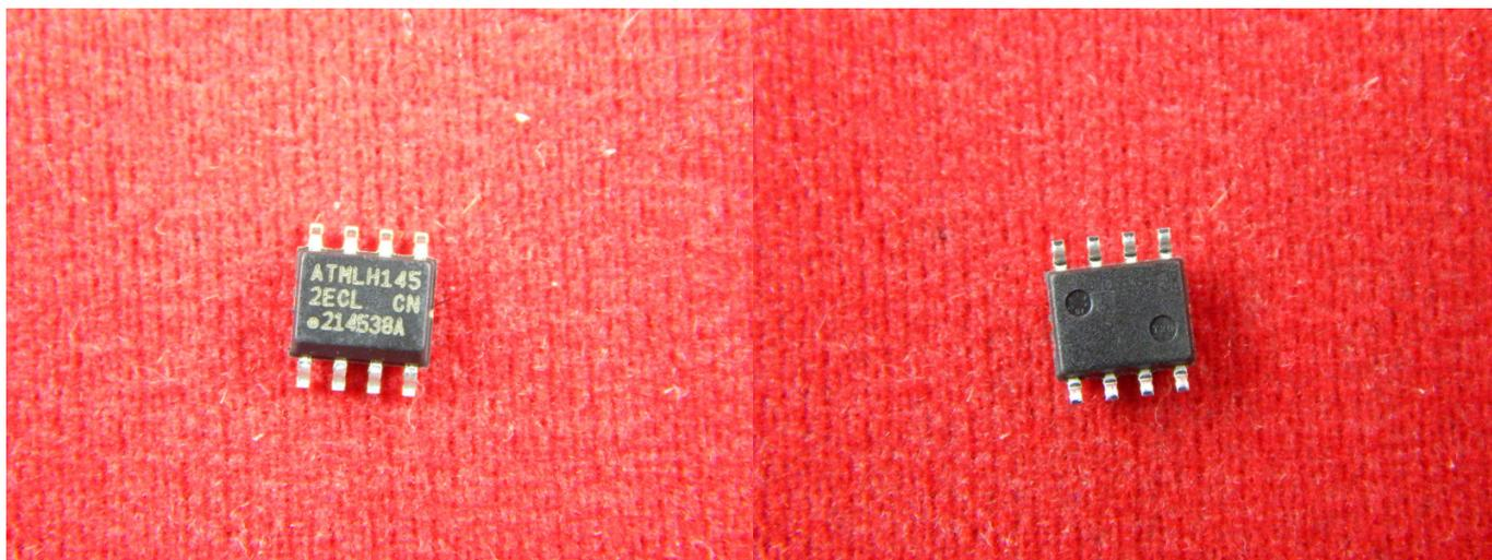
Интегральная микросхема - это совокупность электрически связанных компонентов: транзисторов, диодов, резисторов и так далее, изготовленных в едином технологическом цикле на единой полупроводниковой основе - подложке.
