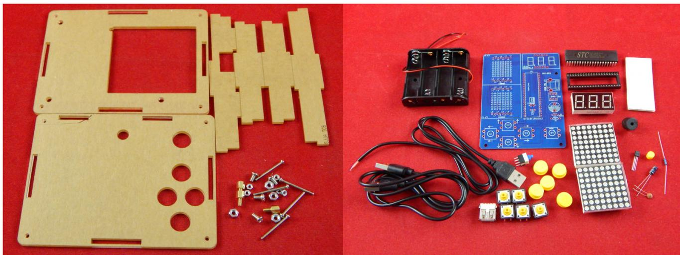
Набор предназначен для освоения навыков пайки электронных компонентов в процессе самостоятельной сборки электронной 8-битной игровой консоли с несколькими встроенными играми. Комплект ориентирован на возраст от 10 лет, и обязательно понравится как начинающим радиолюбителям, так и опытным пользователям.
