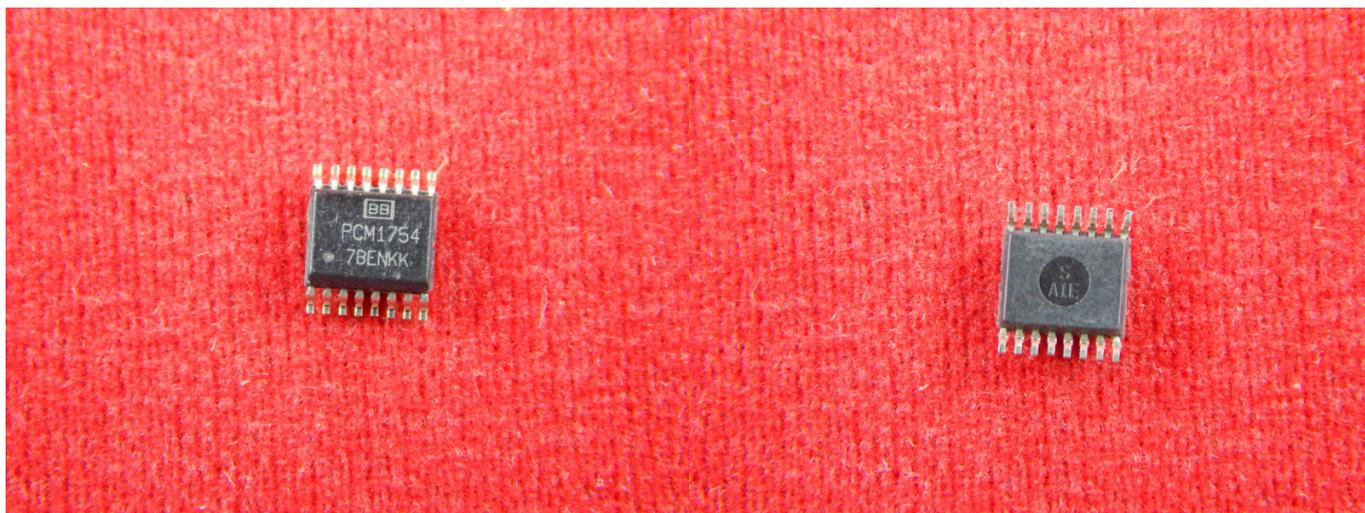
PCM1754DBQR, 24-разрядный дельта-сигма ЦАП. ЦАП — устройство для преобразования цифрового кода в аналоговый сигнал.
