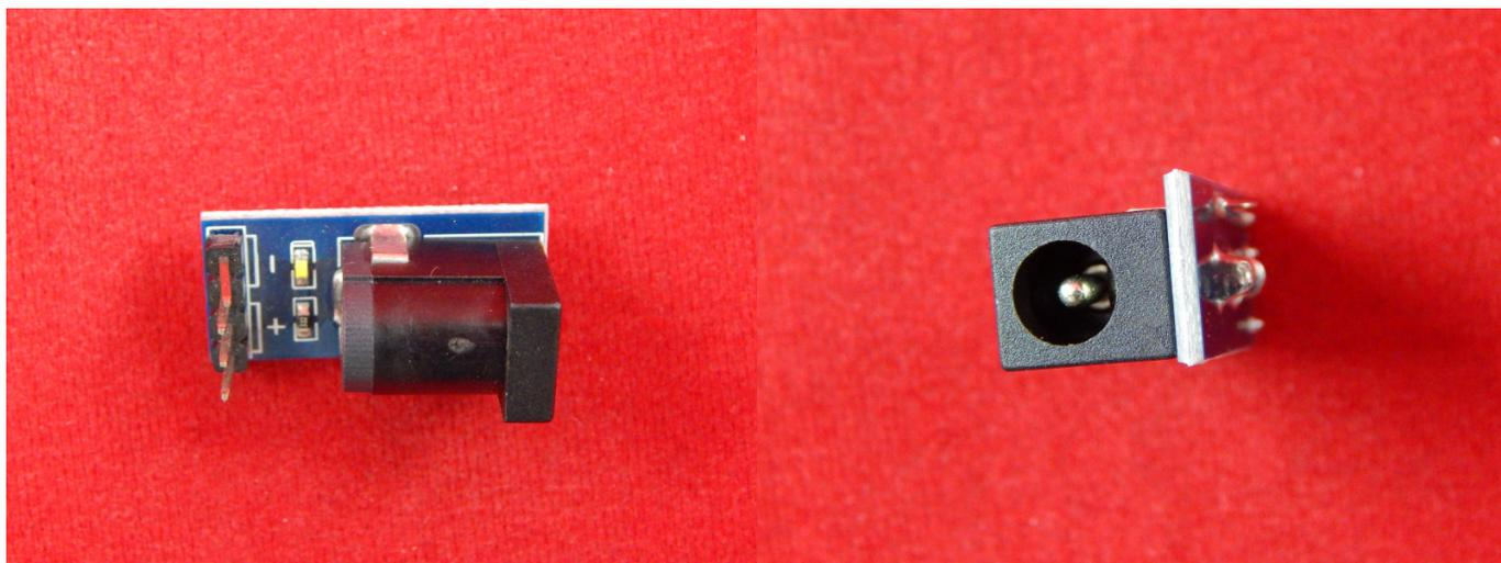
Плата адаптер с разъемом питания постоянного тока DC гнездо 5.5 x 2.1 мм для Arduino.
