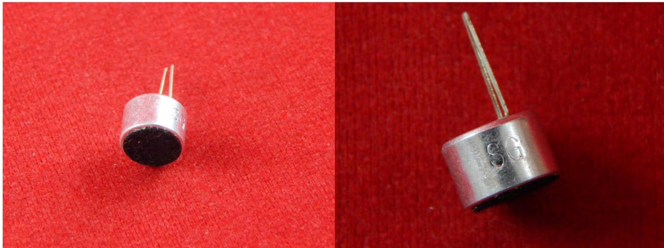
Микрофонные капсулы - это закрытое устройство в корпусе которого происходит преобразование акустических сигналов в электрические, с последующей передачей последних с линию, сеть, эфир или на звуко-записывающее или звукоусилительное устройство.
