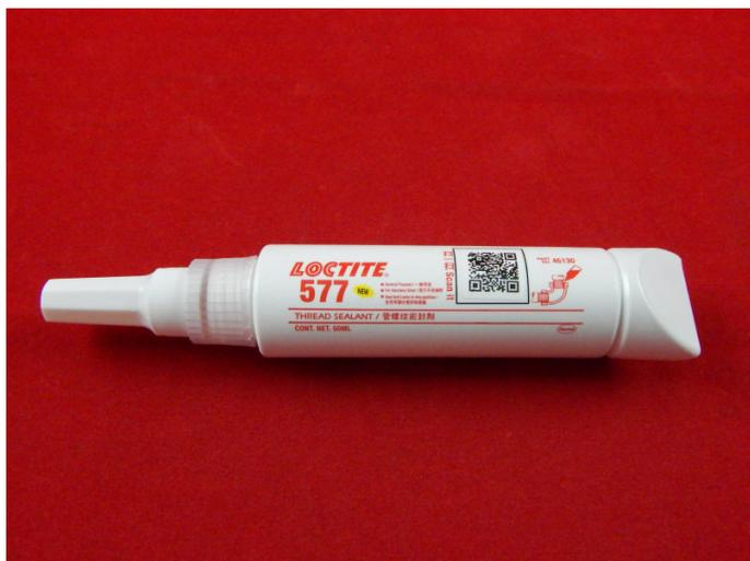
Loctite 577 является однокомпонентным, тиксотропным анаэробным резьбовым герметиком средней прочности с ускоренным временем полимеризации. Продукт полимеризуется в условиях отсутствия воздуха в небольших зазорах между металлическими поверхностями.
