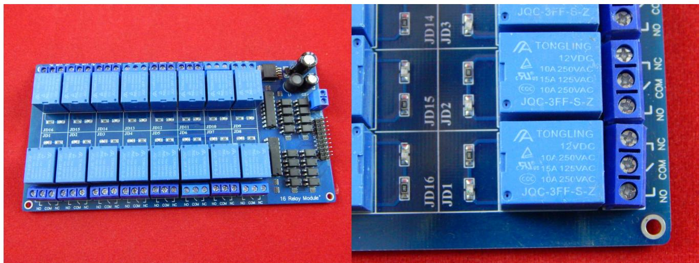
16-канальный модуль реле JQC-3FF-S-Z (12 В) для Arduino и различных микроконтроллеров используется для управления различными приборами с большим входным током. Реле срабатывает при подаче на вход низкого уровня сигнала.
