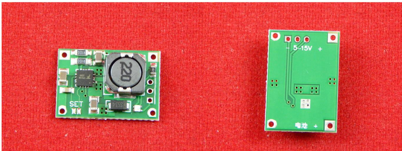
TP5100 модуль зарядного устройства Li-Ion аккумуляторов 2A 1-2S – модуль зарядки для литий-ионных аккумуляторов на контроллере TP5100, питание от 5 до 15 вольт, **программируемый ток заряда до 2 ампер**, функция предзаряда, светодиодная индикация, автоматическое завершение заряда, **заряд 1 или 2 последовательно включенных Li-Ion аккумулятора**.
