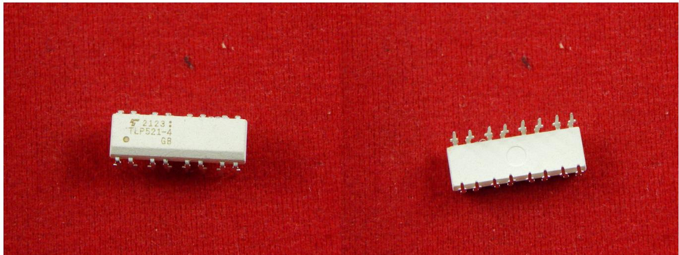
TLP521-4 - Оптопара или оптрон — электронный прибор, состоящий из излучателя света и фотоприёмника, связанных оптическим каналом и объединённых в общем корпусе.
