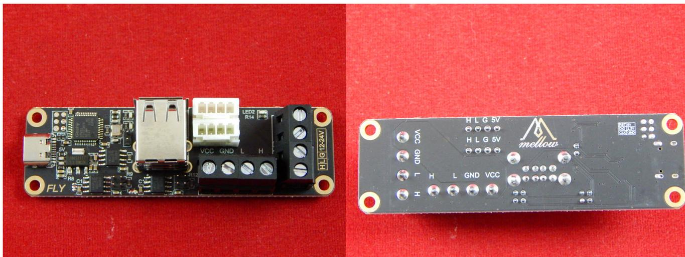
Контроллер UTOC-3 USB от Mellow Fly к CAN Bus адаптер позволяет обращаться к вашему Raspberry Pi с помощью прошивки [Klipper](#).
