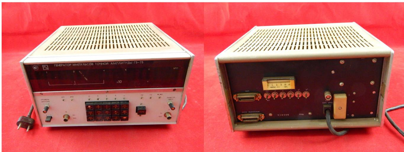
Генератор Г5-75 воспроизводит импульсные электромагнитные сигналы в заданном диапазоне. Используется в лабораториях, промышленных производственных цехах для анализа и обслуживания (ремонта, настройки) различных радиотехнических приборов, вычислительной техники. Основные пользователи устройства — радиолюбители и профессиональные инженеры.
