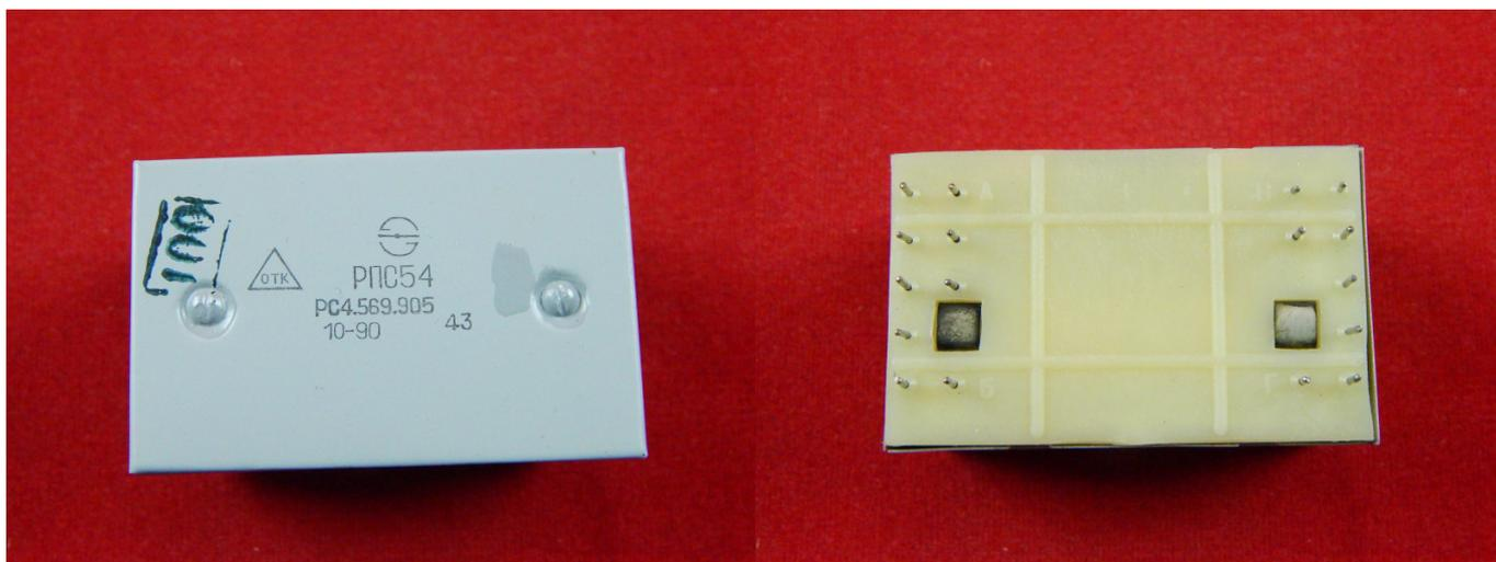
Реле — элемент автоматических устройств, который при воздействии на него внешних физических явлений скачкообразно принимает конечное число значений выходной величины.
