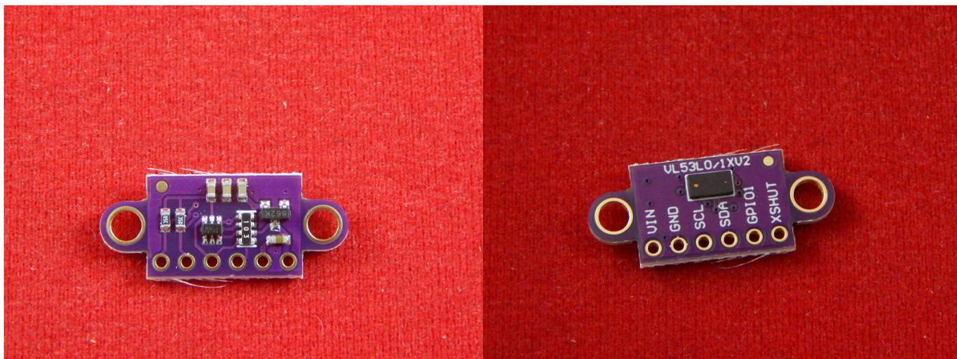
VL53L0XV2 это самый маленький из доступных на сегодняшний день лазерный дальномер, он использует запатентованную технологию Time-of-Flight (ToF). Датчик GY-530 обеспечивает точное измерение расстояния независимо от отражательной способности цели до 2000 мм с разрешением 1 мм. Точность датчика  $\pm 3\%$ . Луч невидим для человеческого глаза.
